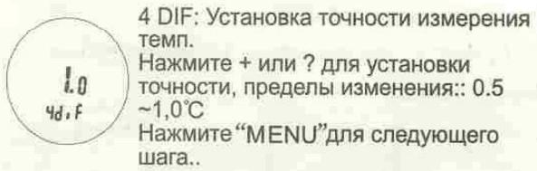
4 DIF: Установка точности измерения темп.
